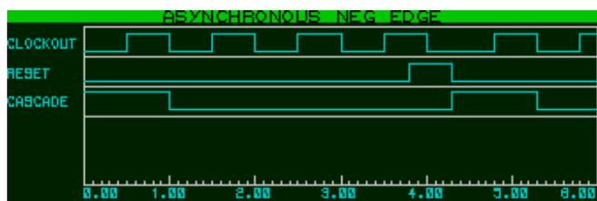
Horloge interne à 1Hz. L'horloge est réinitialisée sur le front descendant de l'impulsion de trigger et le premier bit du pattern est validé à cet instant.
