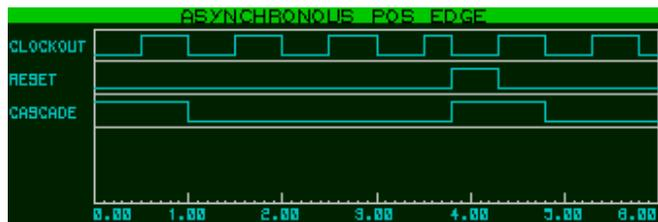
Horloge interne à 1Hz et la pin trigger passe à l'état haut à 3.75sec. L'horloge est immédiatement réinitialisée sur le front positif de la pin trigger, et le premier bit du pattern est dirigé vers les sorties.
