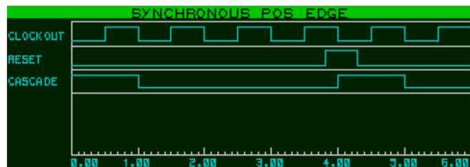
Horloge interne à 1Hz. L'horloge n'est pas affectée par le trigger. L'action du trigger débute sur le front descendant de l'horloge qui suit l'impulsion positive.
