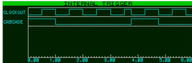
Horloge interne à 1Hz et la pin trigger passe à l'état haut à 3.75sec. La pin Cascade est haute lorsque le premier bit du pattern est dirigé vers les sorties et basse le reste du temps.
