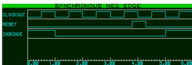
Horloge interne à 1Hz. L'horloge est réinitialisée sur le front descendant de l'impulsion de trigger et le pattern n'est réinitialisé qu'au front descendant de l'impulsion d'horloge qui suit le trigger.
