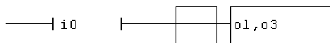
Ici les sorties o1 et o3 seront actionnées toutes des deux si l'entrée i0 est active
