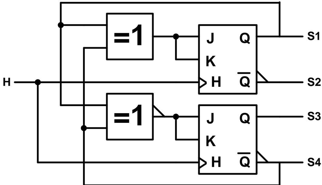
1 - Complétez ci-dessous les chronogrammes des signaux S1, S2, S3 et S4 en synchronisme avec le signal d'horloge H, sachant qu'à l'origine les deux bascules sont à zéro : S1 = S3 = 0 et S2 = S4 = 1 :
