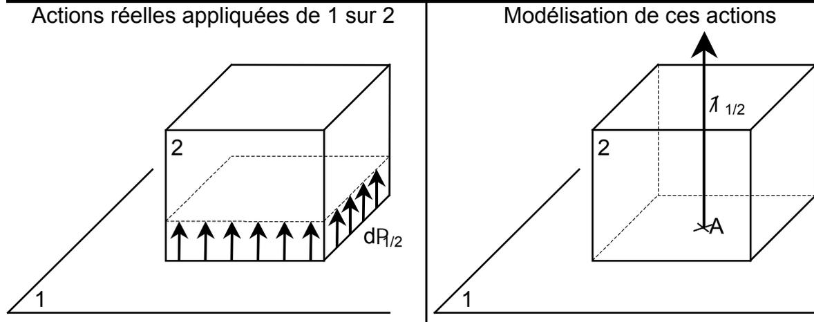
L'action mécanique de contact surfacique est modélisable par un vecteur  $A_{1/2}$  :
