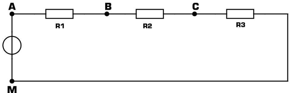
Ajoutez le symbole de la masse sur le schéma ci-dessus. Fléchez chacune des tensions suivantes :  $U_{AB}$ ,  $U_{BC}$ ,  $U_{CM}$  et  $U_{AM}$ . Calculez chacun des potentiels suivants :
