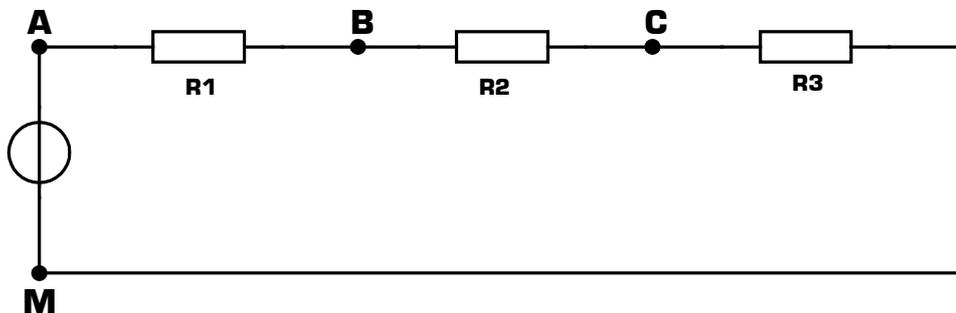
**La tension  $U_{AB}$  est la différence entre le potentiel  $V_A$  et le potentiel  $V_B$  :**
