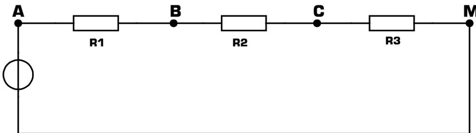
**La tension  $U_{AB}$  se représente par une flèche allant du point B vers le point A. Pour mesurer la tension  $U_{AB}$  on branche la borne « plus » du voltmètre sur A et la borne « moins » du voltmètre sur B.**
