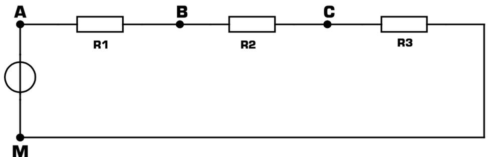
Ajoutez le symbole de la masse sur le schéma ci-dessus. Fléchez chacune des tensions suivantes :  $U_{MA}$ ,  $U_{AB}$  et  $U_{CB}$ .
