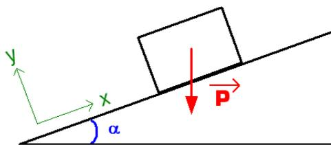
Cas n°4 : **l'axe normal est X et l'axe tangent Y « monte »** [orienté vers le haut sans être vertical]
