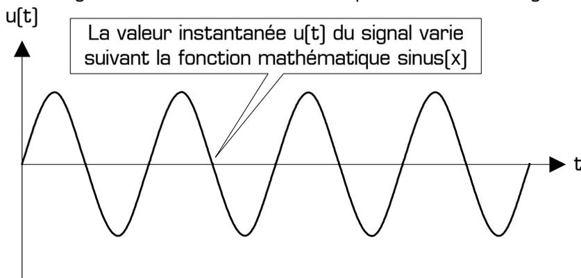
Figure 3 : Exemple de signal alternatif sinusoïdal
