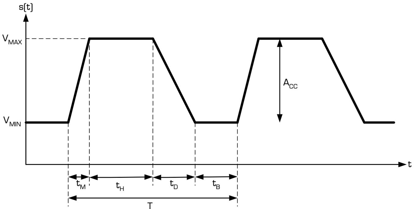
Remarque : dans les 6 grandeurs caractéristiques définissant un signal trapézoïdal, ni le temps bas  $t_B$ , ni l'amplitude crête à crête  $A_{CC}$  n'est indiqué directement. On les retrouve par les relations suivantes :
