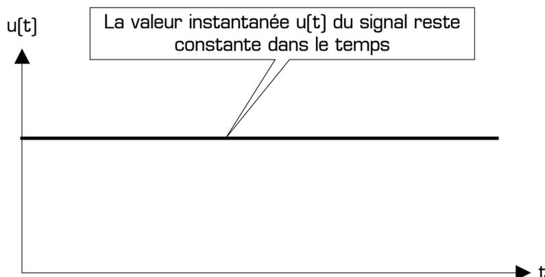
Figure 2 : Exemple de signal analogique continu
