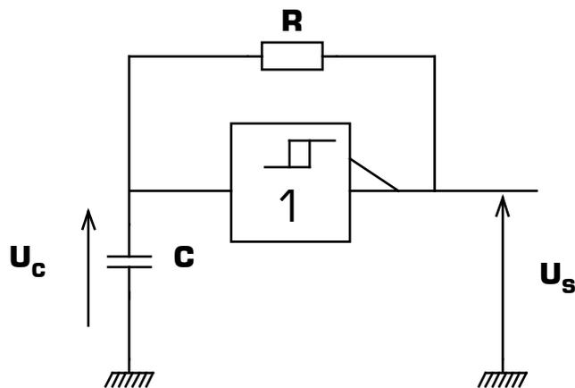
La porte logique Trigger est caractérisée par ses 2 seuils de basculement :
