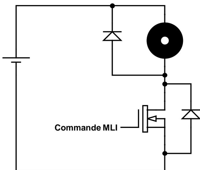
Schéma du hacheur série du Scoot'Elec
