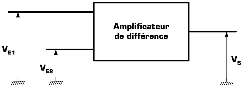
$A_v$  est une grandeur sans unité, et le changement de signe du coefficient  $A_v$  ne modifie pas la fonction réalisée.
