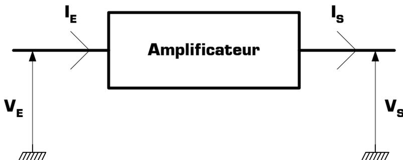
Description des grandeurs d'entrée et de sortie de la fonction amplification :
