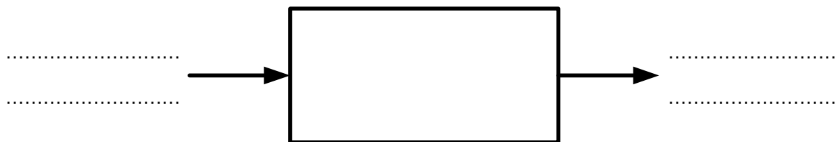
Un vérin transforme de l'énergie pneumatique d'entrée en énergie mécanique de sortie
