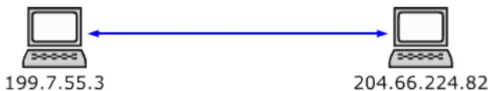
Avec UDP/IP, on peut être plus précis: on envoie des données d'une application x sur l'ordinateur A vers une application y sur l'ordinateur B.
