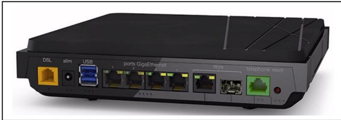
Une box wifi (ici la livebox d'orange) est un appareil qui fait à la fois office de switch, de routeur et modem. On peut réaliser un réseau local filaire ou/et sans fil et communiquer sur internet via le fournisseur d'accès (orange)
