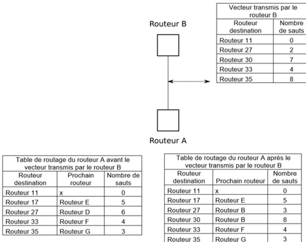
Dans l'exemple ci-dessus, le routeur A reçoit le vecteur transmis par le routeur B.
